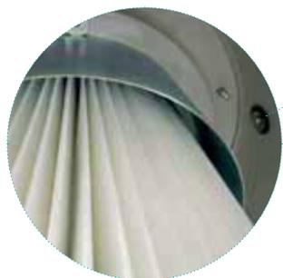
Am Körper der Absaugzentrale ist der Filterschutzflansch aus **verzinktem** Stahl befestigt. Der Schutz gewährleistet die Unversehrtheit der Filterpatrone auch beim Ansaugen großer Mengen von Staub oder bei Vorhandensein von unregelmäßigen Rückständen.
